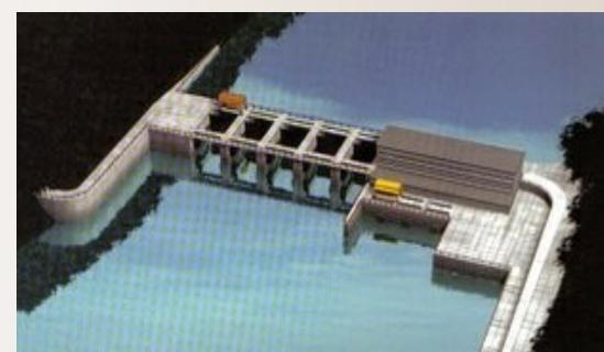
Primer, protočne pribranske mini hidroelektrane, kakve je moguće graditi na reci Pek i njenim pritokama, snage oko 300 kW.
